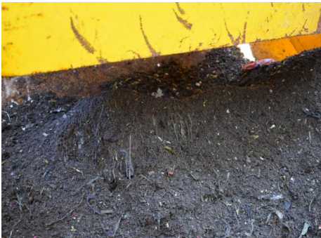
Les peaux de bananes, textiles... sont transformés en une « poudre ». « C'est la base d'entrée en méthanisation » explique Philippe Testevuide, - sur la photo de dr. - directeur TIRU (Traitement par Incinération des Résidus Urbains).
