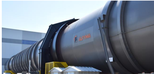
Les tubes malaxeurs dégradent les déchets. Ils tournent en permanence et la température avoisine les 34°. À la sortie, les déchets sont réduits en « poudre ». La transformation se fait par les bactéries.
