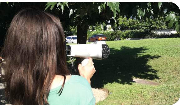
Mesure de la concentration d'odeurs à l'aide d'un olfactomètre de terrain (Phase 2)
